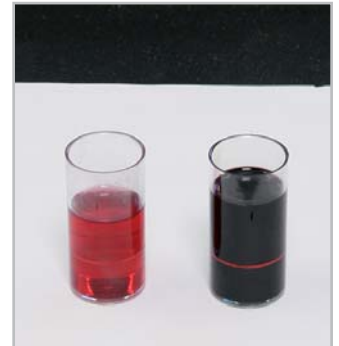
Anhand der Ölproben kann der Kunde sofort erkennen, wie hoch der Verschmutzungsgrad seines Öles ist: rote Farbe - optimal, schwarze Farbe - starke Verunreinigung
